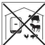
Den Wechselrichter nicht montieren in:
