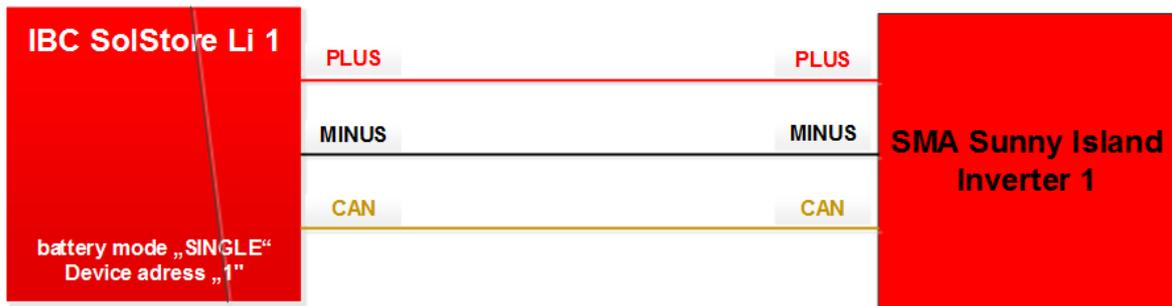
Bild 13: Einphasiger Betrieb an einem IBC SOLSTORE LI
