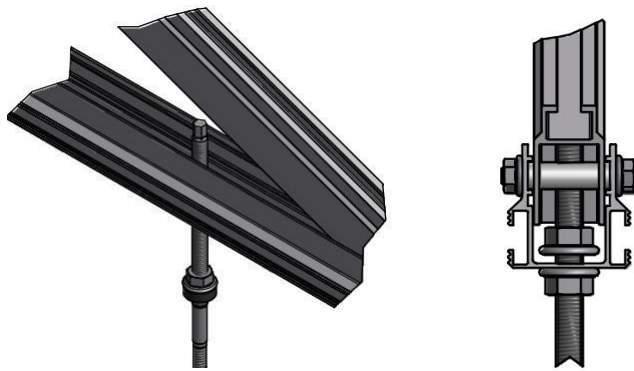
Abbildung 126: Montage mit einer Stockschraube
