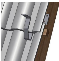
Abbildung 6: Dachhaken auf Dachsparren
